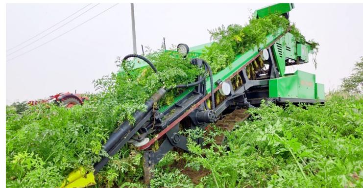
科学院蔬菜花卉研究所庄飞云研究员表示,该款胡萝卜无人收获机采用自走式设计,与国外的背负采收机相比,具有结构紧凑、灵活性等特点,更适合国内不同类型的地块和需求,采收破损率低于3%,作业稳定,技术水平在国内外具有先进性。
